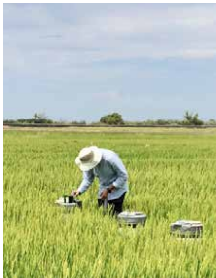
Aktueller Feldversuch in einem Reisfeld in den USA, in dem versucht wird, die Abundanz und Aktivität der Kabelbakterien zu stimulieren. Vier Messkammern dienen der Bestimmung der Methanemissionen verschiedener Behandlungen. Quelle: Vincent Scholz, Tillmann Lueders.
